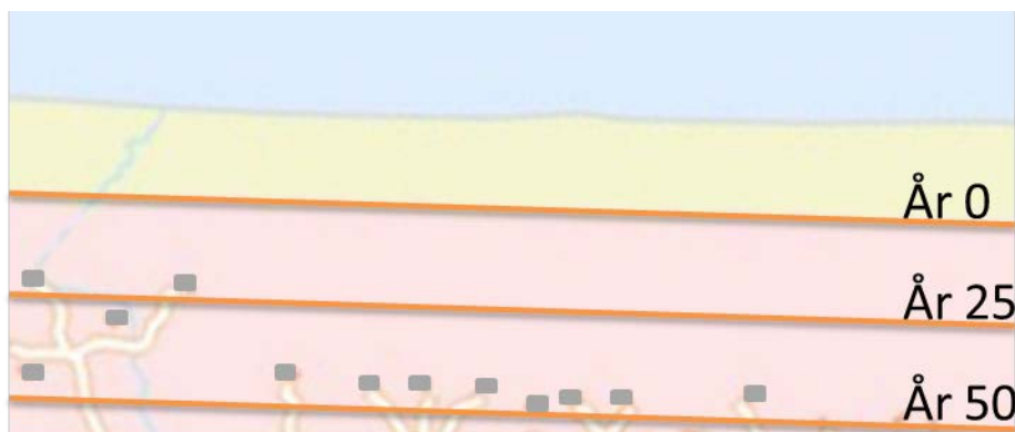
Figur 6 Eksempel på differentieret nytteværdi over tid. Orange linjer viser skræntens tilbagerykning i løbet af 50 år
