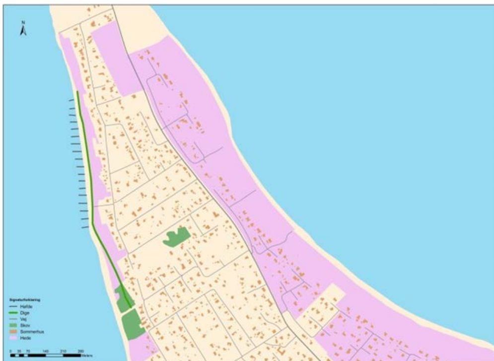
Figur A7 Projektscenarie 1: Dige med høfder foran
