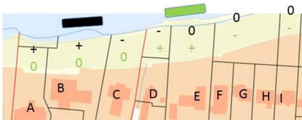
Figur 7 Bølgebryderes positive og negative effekt på kystlinjens tilbagerykning
