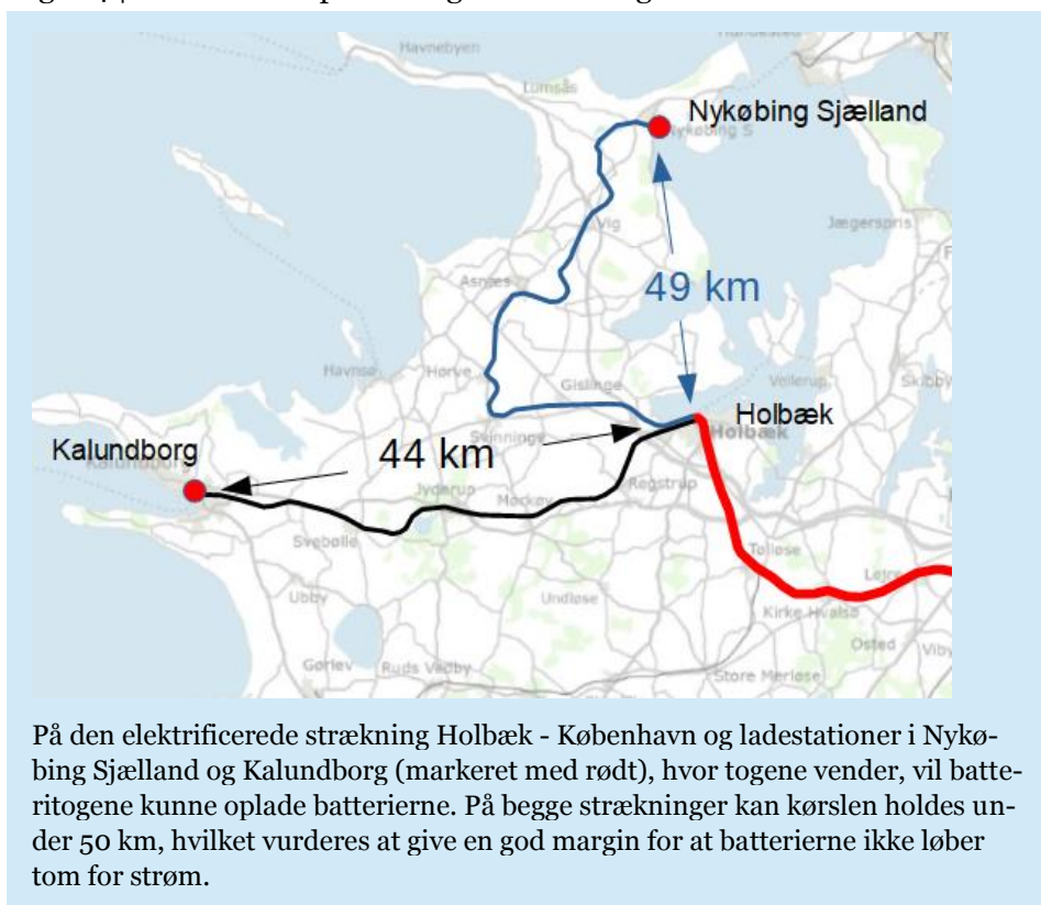
Figur 4 | Batterikørsel på ledningsfri strækninger
